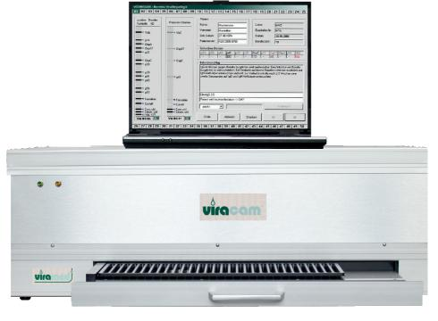
Für 20er, 30er, 48er und 50er Inkubationswannen Scannt bis zu 50 Streifen in zwei Minuten Ist speziell für die Auswertung mit ViraScan® konzipiert Speichert das Bildmaterial zur sicheren Archivierung
